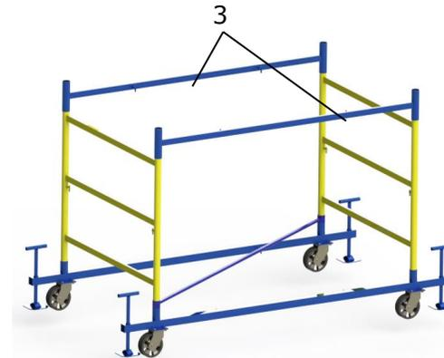
**3.6** Закріпити конструкцію стяжками секції (4).
